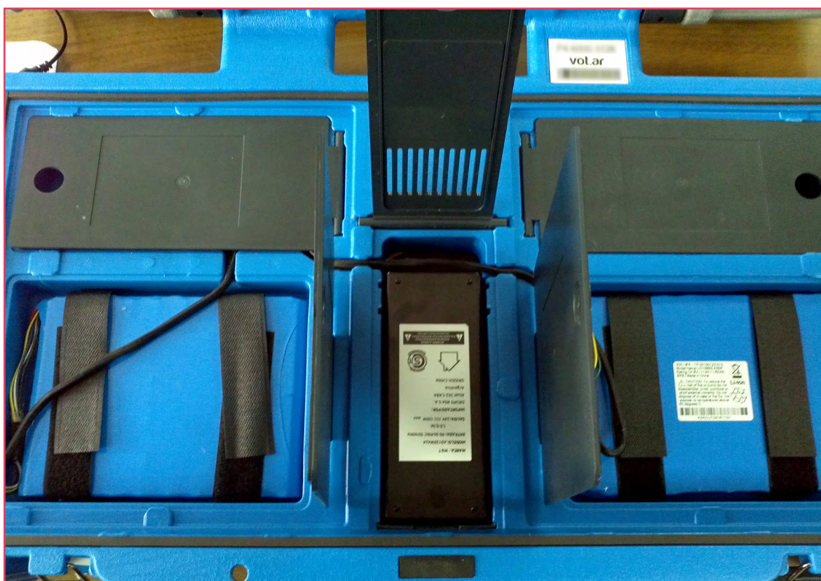
FIGURA 3: Vista inferior (baterías y cargador)
